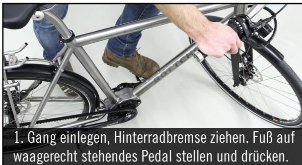
1. Gang einlegen, Hinterradbremse ziehen. Fuß auf waagerecht stehendes Pedal stellen und drücken.
